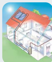
Energía Solar Térmica
