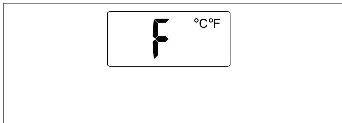
Se visualiza la unidad actual y el valor para la pantalla secundaria parpadea con el fin de indicar que se puede modificar tal valor. Para cambiar el valor de Fahrenheit a Celsius y viceversa, debe girarse la perilla de control.
