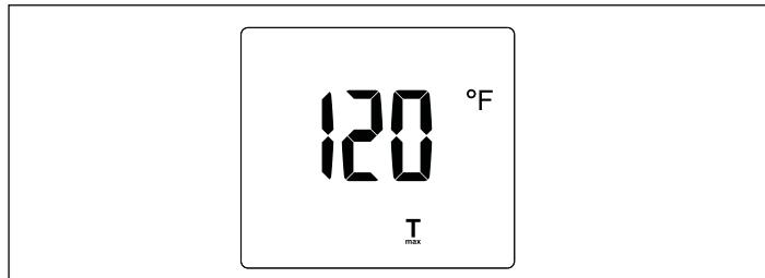
En el menú de ajuste de  $T_{max}$ , la pantalla parpadea, lo que indica que se puede cambiar el valor girando la perilla de control. El valor  $T_{max}$  puede aumentarse girando la perilla de control hacia la derecha y disminuirse girándola hacia la izquierda. El valor  $T_{max}$  puede desactivarse al girar la perilla de control hacia la izquierda, pasando la opción de  $20^{\circ}\text{C}$  ( $68^{\circ}\text{F}$ ). En la pantalla se indicará "Off" si el valor  $T_{max}$  está inactivo.
